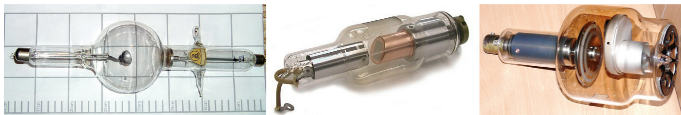
1. kép balra egy 100 éves álló anódú röntgenső, középen egy modern álló anódú röntgenső, jobbra pedig egy mai modern forgó anódú röntgen betétcső látható
